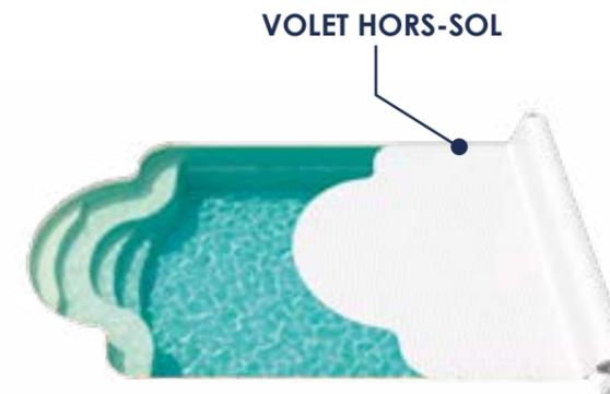
Voilet roulant placé à l'extrémité du bassin, sur un enrouleur tournant autour d'un axe se déroulant à la surface de l'eau.
